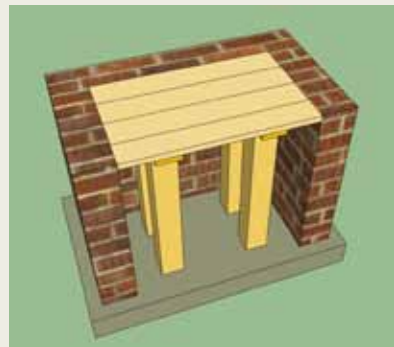
3 Сооружают столик-подпорку для опалубки
